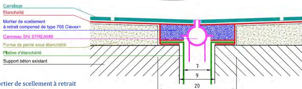
*Nota:* Mise en place d'un mortier de scellement à retrait compensé de type 705 Clavex+, sur toute la hauteur du SNI'STREAM® (dito détail ci-dessus) et de chaque côté, sur une largeur minimale de 10 cm.
