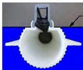
Arase du mortier de scellement à retrait compensé de type 705 Clavex+
